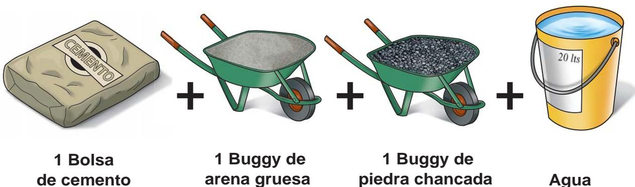
A diferencia de otros tipos de concreto, este debe hacerse de preferencia usando una mezcladora. Si se hace de manera manual obtendremos una mezcla no uniforme. Es decir, que no tenga la misma resistencia en todo el techo.
